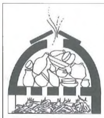
Figura 2. Horno cerámico para la fusión de los minerales de cobre. Mesopotamia.
